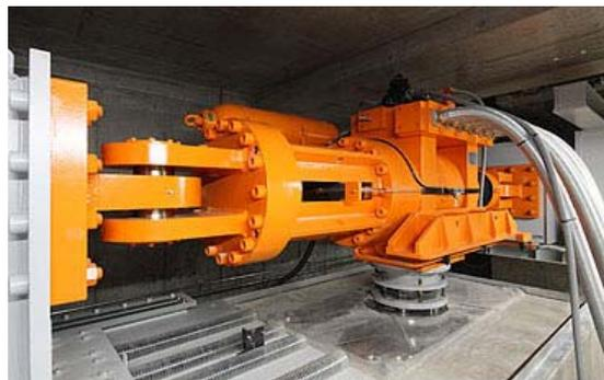
図 4-6 構造体を動かすアクチュエータ<sup>4-8</sup>
