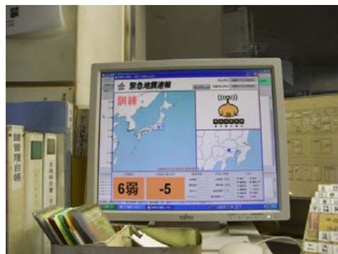
写真 2: 統括防火管理者用 PC での緊急地震速報の画面
