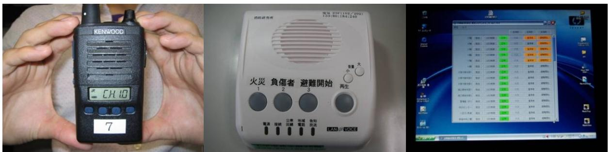
写真 4-13 : 工学院大学における非常用通信システムの複層化の例 (右 : 携帯用無線、中・右 : 館内 IP 網を利用して緊急通報と把握を一斉同報できる緊急情報システム。各学科事務室などから火災などのボタンを押すだけで、災害対策本部でその情報が表示される)
